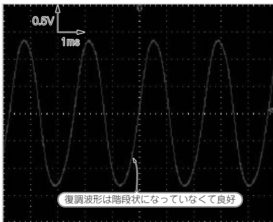
(b) ラジオ受信機で受信した復調波形を測定してみると、階段状になっていない
