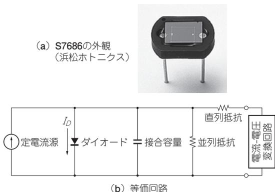
図1 フォトダイオード(PD)の等価回路
