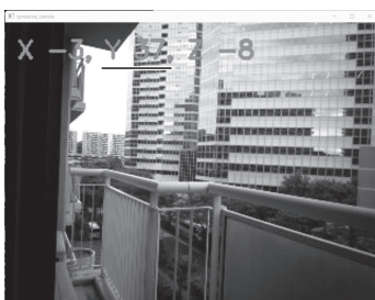
図1 マルチIMUの上にカメラを固定してカメラがどちらを向いているかを測定する 画像表示はPC
