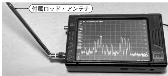
〈写真1〉 まずは最もカンタンに試せるFM放送の電波を tinySA Ultraで見してみる
