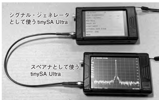
〈写真2〉 tinySA Ultra のシグナル・ジェネレータ機能を使った10MHz正弦波出力を測定する
