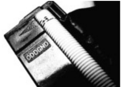
写真1-4 ATA規格の80芯ケーブルの1番ピン表記 ODD GNDと記されているので奇数ピンがグラウンド
