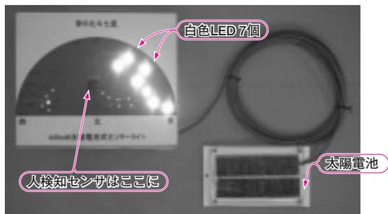
写真4-1<sup>(1)</sup> 440 mWの太陽電池を使った人検知センサ付き自動ON/OFFライト
