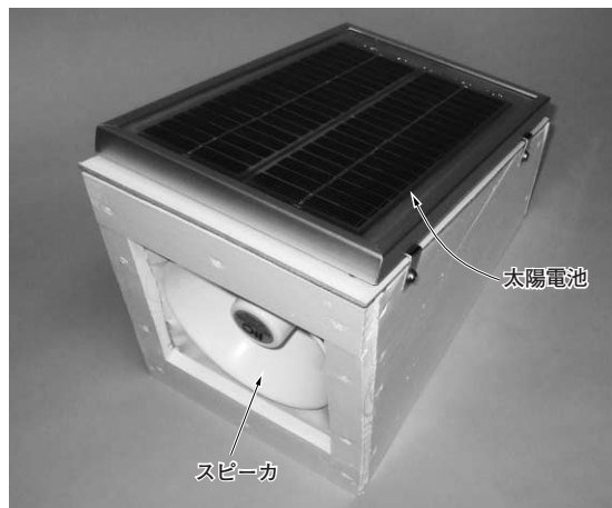
写真3-1 製作したカラス撃退器
