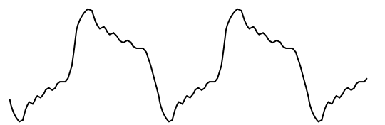
図2 LPF を使って矩形波から高調波成分を除去する例 群遅延時間一定特性だと波形が崩れない
