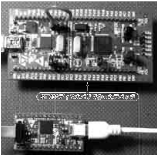
(a) SWD 対応のさまざまな小型マイコンがデバッグできる
