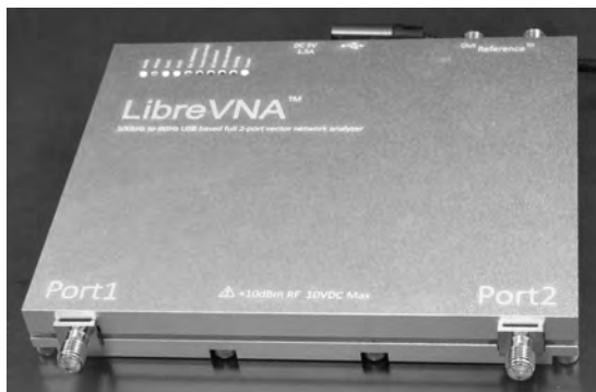
〈写真1〉オープン・ソースで開発された“LibreVNA”は、ついに6 GHzまで測れるようになった
