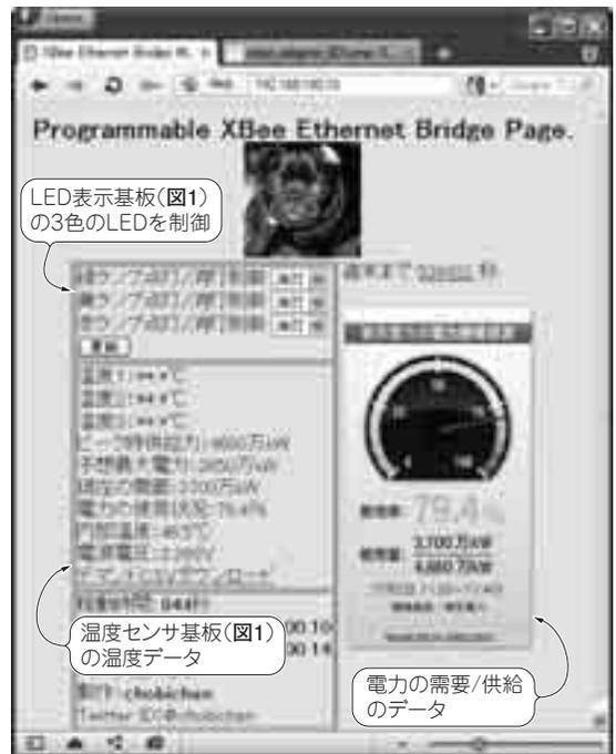
図2 XBeeゲートウェイ基板上のProgrammable XBeeにはウェブ・サーバが実装されているのでパソコンからアクセスできる電力の需要と供給のデータを東京電力のサイトから読み出して電力の需要と供給の割合を計算。結果に応じてXBeeを介して遠隔でLEDを点灯している。さらに室内の温度計測結果をXBeeを介して表示もしている
