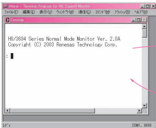
図1 モニタにコマンドを送信して処理結果を受信する コマンドや処理結果は、すべてシリアル通信で行われる
