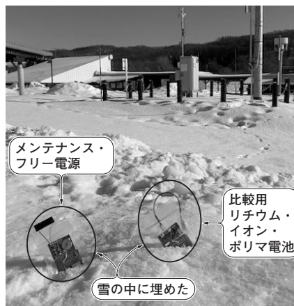
(b) IoT気温測定の実験 (奥は気象庁の観測設備)
