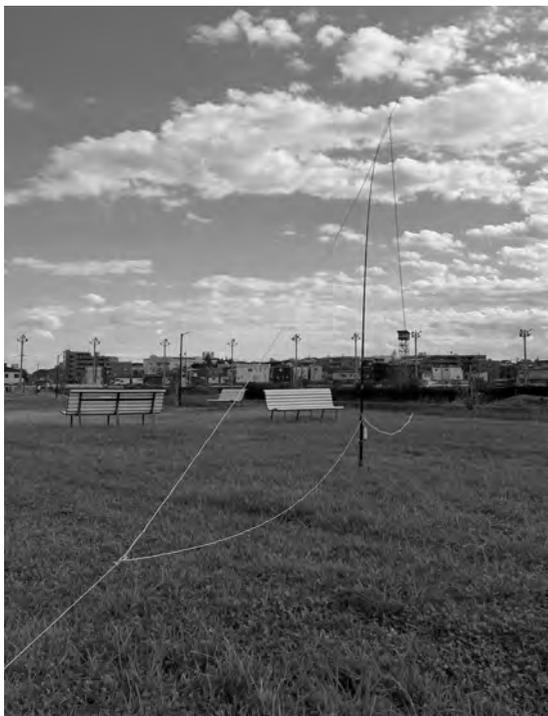
〈写真1〉海外のAMラジオ放送を受信するために製作した遠距離用の指向性K9AYアンテナ
