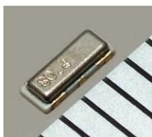
写真1 セラミック振動子
