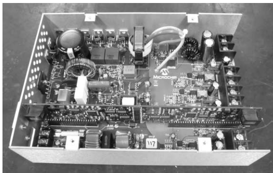
写真1 dsPIC を使った AC-DC コンバータのリファレンス・デザイン
