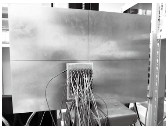
写真1 超音波で欠陥点を探る技術…アレイ化した超音波エミッタを使うと非破壊検査が行える 空中超音波フェーズド・アレイを使った非破壊検査の実験
