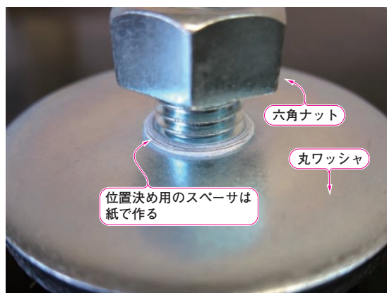
写真1 丸ワッシャのセンターリングのための紙部品
