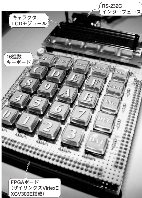
写真1 オープン・ソースSH-2 CPUコアIP「Aquarius」の実験ボード ヒューマンデータ社製のFPGAボード(ザイリンクスVirtexE搭載)の上に、キャラクタLCDモジュール、16進キーボード、RS-232Cコネクタを備えたインターフェース・ボードを重ねてある
