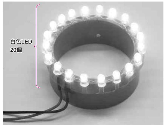
写真2 白色LEDを20個、塩ビ・パイプの周囲に固定
