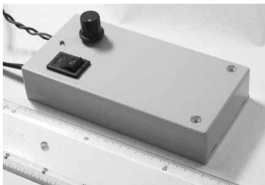
写真4 図1の回路をプラスチック・ケース(タカチ: SW-120S, 60×120×24mm)に組み込んだ調光回路
