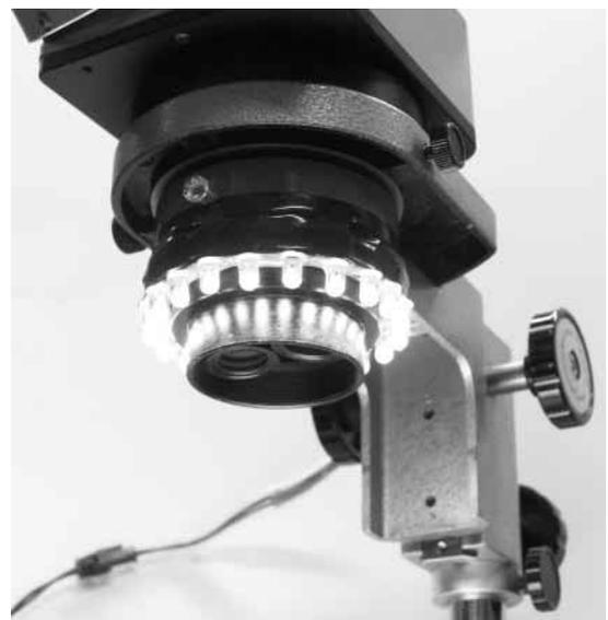
写真3 顕微鏡に固定した白色LED
