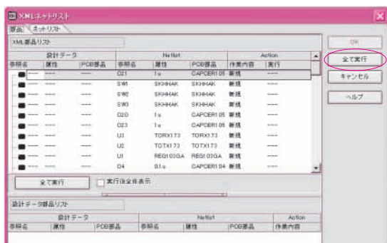
図1 XML ネット・リスト読み込みダイアログ ここで、PCB CADソフト(WinPCB)に回路図データを転送する
