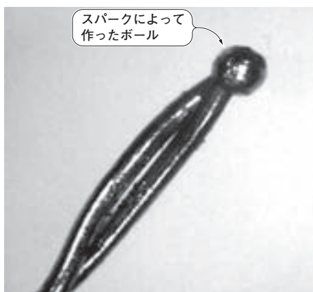
写真1 スパーク溶接により製作したφ0.1mmのK型熱電対の先端部
