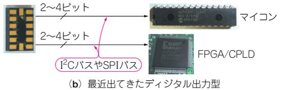
図1 マイコンやFPGAと直結できるデジタル出力型が増えている
