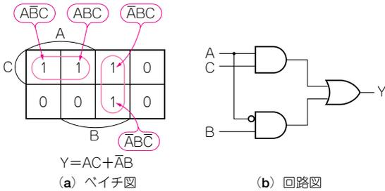
図3-5 例題のベイチ図と圧縮された回路
