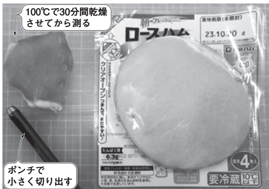
(a) ターゲットのスライス・ハム(水分が多すぎると測れないので、乾燥させてから小さく切って測定)
