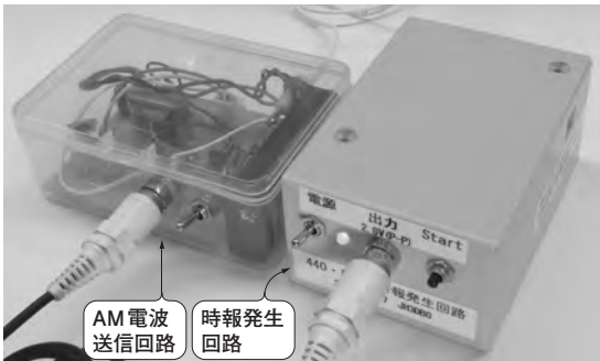
写真1 製作した「プッ・プッ・プッ・ピー〜」時報発生器と電波に乗せるためのAM送信器
