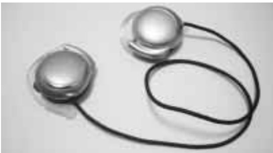
写真3-1 耳かけヘッドホンにMP3再生回路，USBインターフェース，電池などのすべてを収納！(自作キットの頒布サービスを予定)
