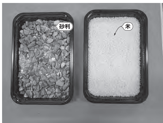
写真1 何ごとも回路に見えてくる…道路に使う砂利から食べ物までNanoVNAで水分量を測れる 水分量測定を行う対象。どちらも加水して水分量の異なるサンプルを6種類用意した
