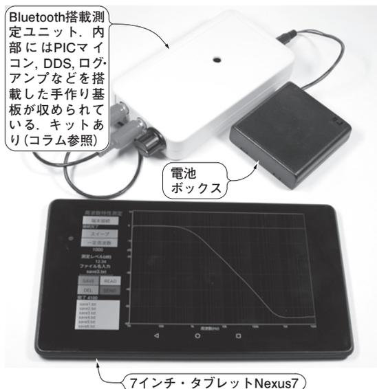
Bluetooth搭載測定ユニット。内部にはPICマイコン、DDS、ログアンプなどを搭載した手作り基板が収められている。キットあり(コラム参照)
