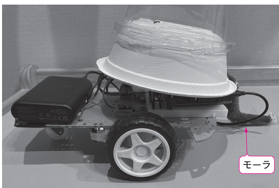
写真1 製作した猫のおもちゃ用猫じゃらしロボット 左右のモータで猫のおもちゃ(モータ)を動かして、猫の興味を引く
