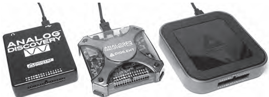
(a) Analog Discovery(初代) (b) Analog Discovery 2(2代目) (c) Analog Discovery 3(最新型)
