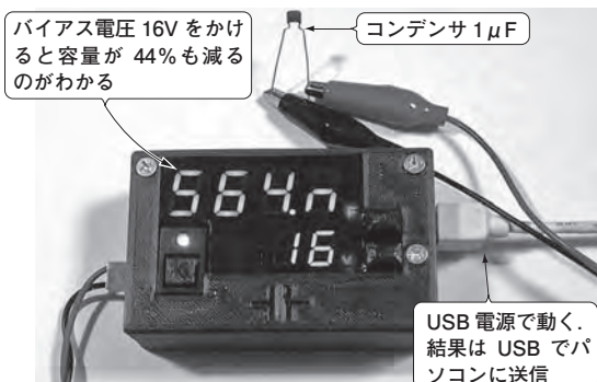
写真1 直流電圧を加えながら容量値を測ることができる「バイアス付きコンデンサ容量計」
