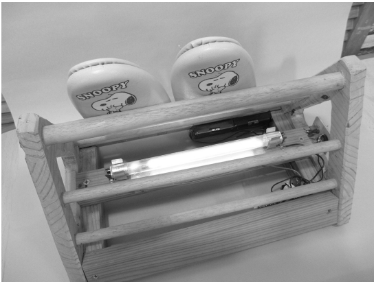
写真1 スリッパを消毒できる紫外線殺菌灯を ChatGTP 協力のもと製作してみる
