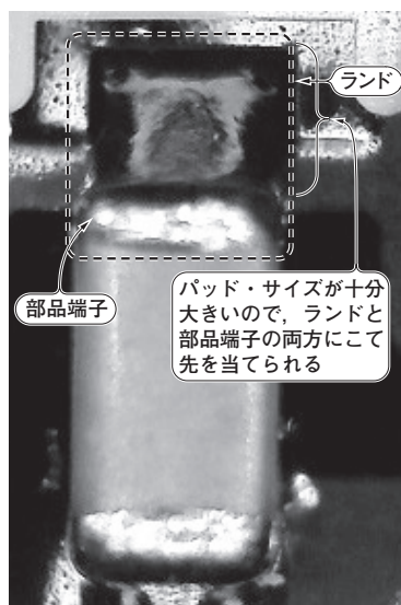
(b) 銅泊ランドのサイズが適切なフットプリント
