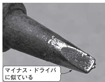
写真2 主に使っているものはD型と呼ばれる先端がマイナス・ドライバに似た形状
