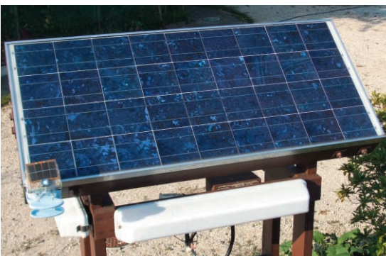
写真1 太陽電池を使った門灯と雨降り警報器 (左下) 自作した門灯は5年間大きな故障なく動作している
