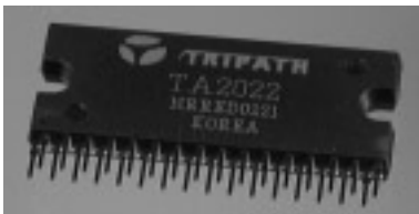
写真1 ワンチップで100W × 2を出力できるパワー・アンプIC TA2020
