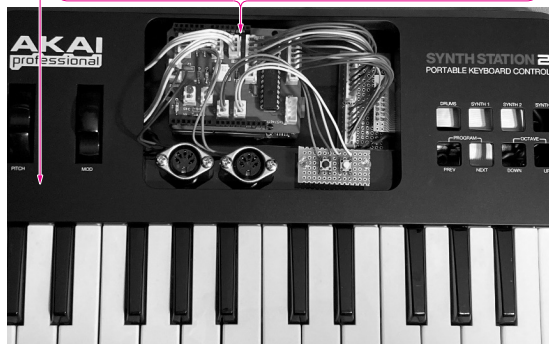
写真1 MIDIキーボードに Spresense ボードと拡張基板を追加してオリジナル電子楽器を作る 鍵盤操作を(MIDI構成で)アンプ/スピーカに出力するだけでなく、MIDI入出力も可能で、ほかのMIDIコントローラやPCとつながこともできる
