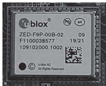
写真2 M5Stack本体とバッテリーの間にM5F9Pモジュールが挟まれている
