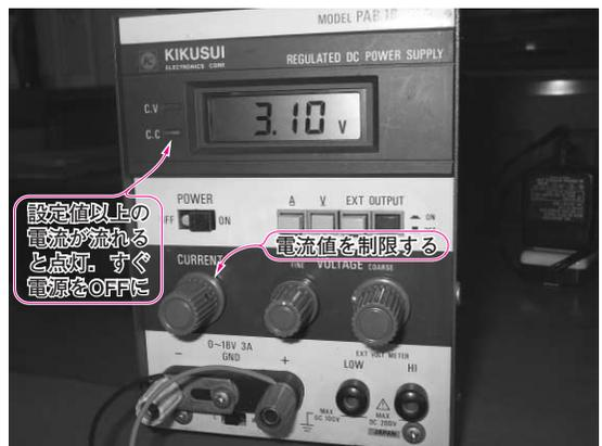
写真 1-1 初めて基板に電源を入れる前に安定化電源の電流リミット機能を設定する
