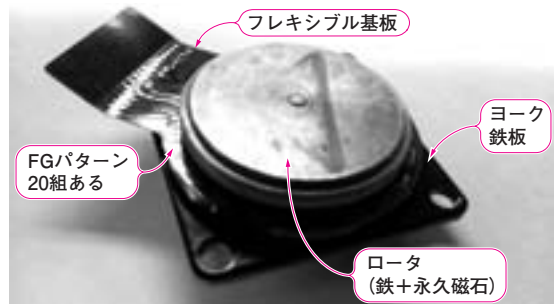
写真1 5 W 出力の小型扁平ブラシレス・モータ DM1 個人でも1個から買える [テクノバッグ, http://www.technobag.jp/ ]
