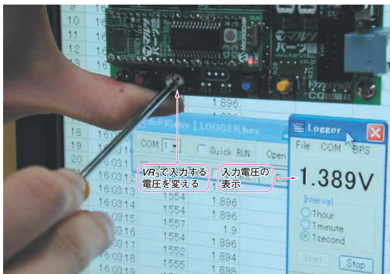
写真1 VR 3 で変化させた電圧をA-D変換機能を使ってパソコンに取りこむ
