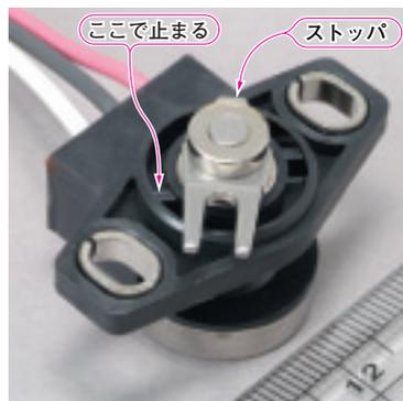
写真4 有効電気角が±45°でリターン・スプリング付きのQP-3HA-L(緑測器)
