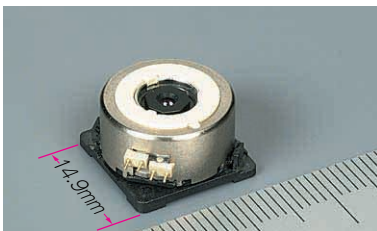
写真1 130万画素、1/3インチ、15fpsでオート・フォーカス機能付きCMOSカメラ・モジュールFPDF8Xシリーズ(アルプス電気)
