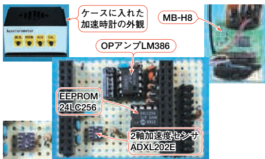
写真6 第8章では加速度計を製作 加速度センサ・インターフェースとウェブ・ファイル再生のテクニック
