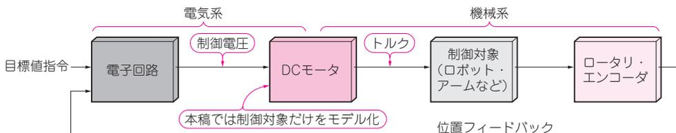
図1 モータを含む制御システムを作るときは電気系と機械系の両方を考える
