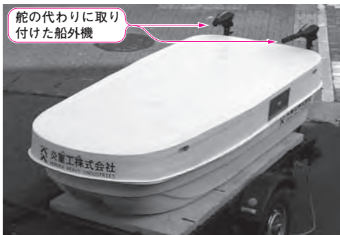
写真1 舵なし向き制御実験を行った船舶ロボット 2軸0舵船(skid-steer)
