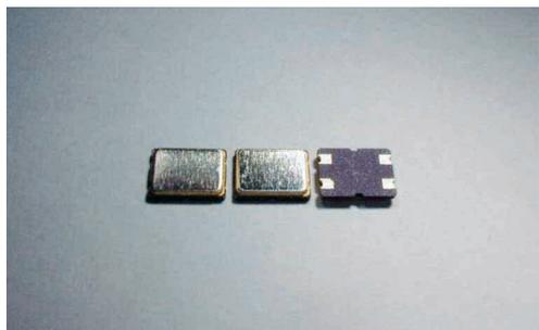
写真6 セラミック・パッケージの水晶振動子
