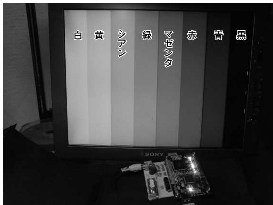
写真1 製作したNTSC生成回路を実装したCPLD基板(MAX II Micro Kit)を利用してコンポジット信号を映している様子
