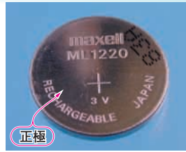
写真1-5 コイン形二酸化マンガン・リチウム2次電池 (ML1220)
